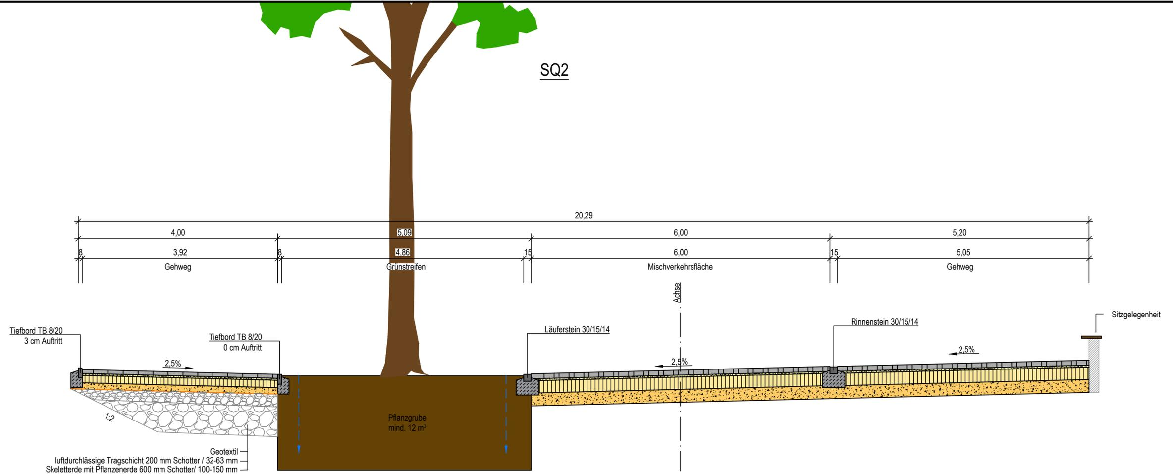
luftdurchlässige Tragschicht 200 mm Schotter / 32-63 mm
