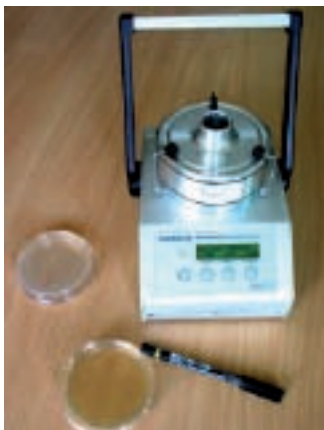
Raumluftmessung auf Schimmelpilze mit dem Luftkeimsammler Quelle: www.enius.de
